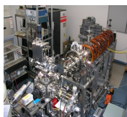
原子の抜けた穴を検出する 陽電子顕微鏡
